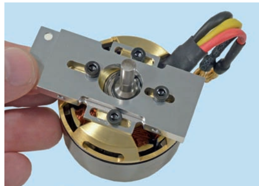
Abb. 9.7 – Solange die Schrauben noch nicht fest angezogen sind, lässt sich die Platte vor- und zurückschieben. So lässt sich die Welle in die für das Hauptantriebszahnrad ideale Position bringen.
