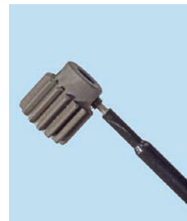
Abb. 9.7 – Solange die Schrauben noch nicht fest angezogen sind, lässt sich die Platte vor- und zurückschieben. So lässt sich die Welle in die für das Hauptantriebszahnrad ideale Position bringen.
