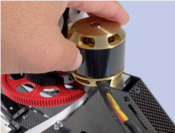
Abb. 9.18 – Durch Drehen der Motorglocke oder des Hauptzahnrad wird der Papierstreifen zwischen beiden Zahnradern hindurchgedreht.
