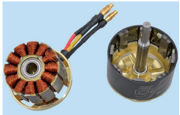
Abb. 9.3 – Innenleben des Motors des RC-Helikopters: Links ist der Stator mit den Motorwicklungen zu sehen, rechts der Rotor, auch Motorglocke genannt, in dem die Dauermagnete kleben.
