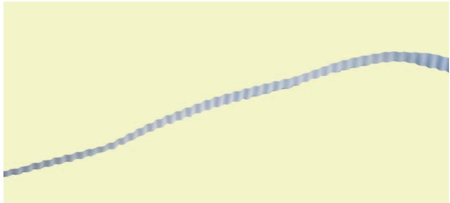
Abb. 9.20 – Erhält er dabei ein gleichmäßiges Zahnradmuster, deutet das auf ein korrekt eingestelltes Zahnflankenspiel hin.
