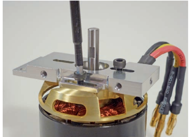
Abb. 9.6 – Der Motor ist so anzuschrauben, dass sich seine Welle ungefähr in der Mitte des großen Langlochs befindet.
