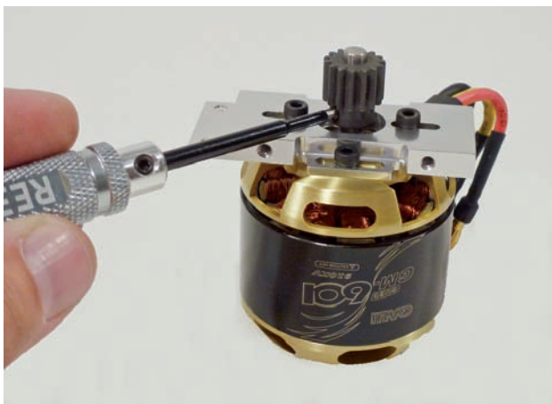
Abb. 9.9 – Das Antriebszahnrad ist so auf die Welle zu schieben, dass es bündig mit dieser abschließt. Anschließend ist das Zahnrad mit den beiden Gewindestiften an der Welle zu fixieren.
